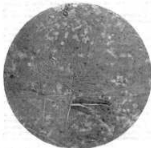
Рис. 3. Сросстки мельчайших напелек куприта и иголки халькотрихита в шлаковой массе. Обр. № 18, \times 90 .
