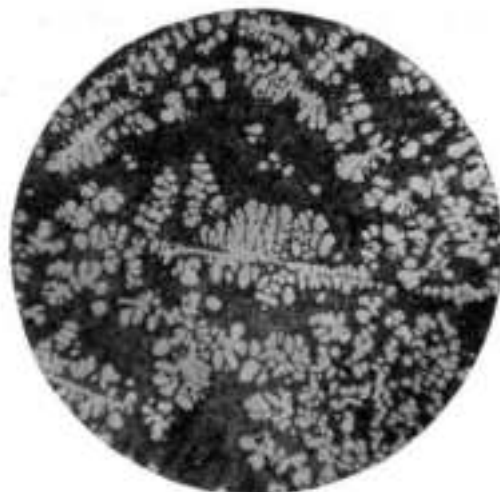
Рис. 1. Прорастания куприта в шлаковой массе с образованием псевдодендритовой структуры. Обр. № 13, \times 90 .
